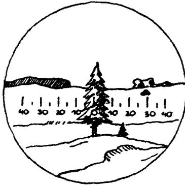
Bild 2. Die Anwendung der Strichplatte im Doppelfernrohr zur Zielbezeichnung.
